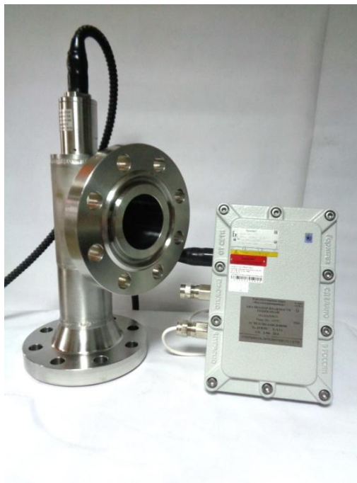
Рисунок 2 – Внешний вид влагомера FIZEPR-SW100 с угловыми датчиками
